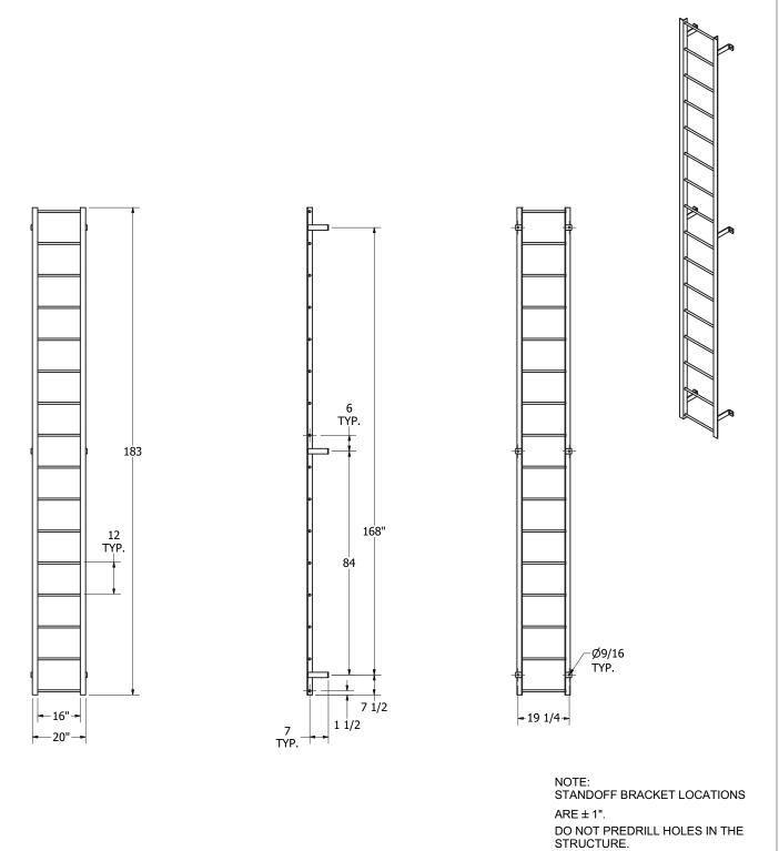
HOLES SHOULD BE MATCH DRILLED TO INSURE PROPER ALIGNMENT
